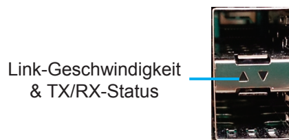
Abbildung 4. Ethernet SFP Port LEDs
